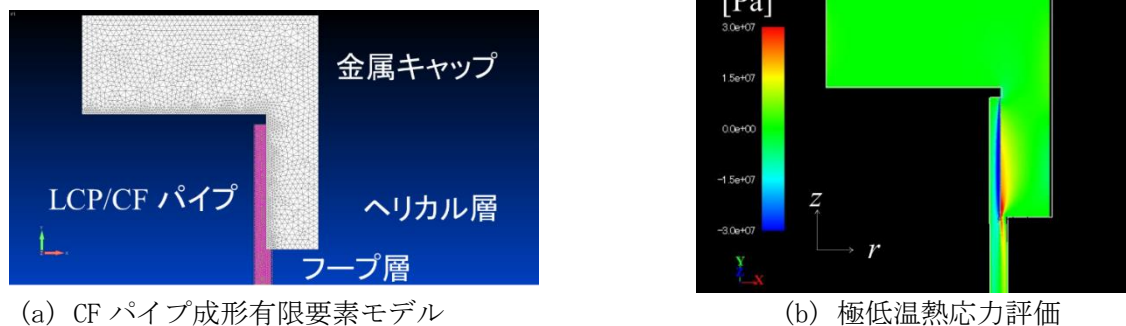
図2 宇宙輸送機用熱可塑CFRP製パイプの成形シミュレーション
