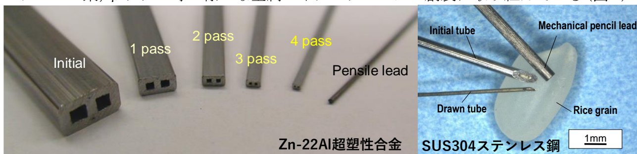
図2 ダイレス引抜きによって創製した金属マイクロチューブ
