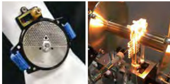
▲静電気を生じて発電する回転型エレクトレット振動発電器 ▲マイクロ石炭流路内に形成された冷炎の計測
