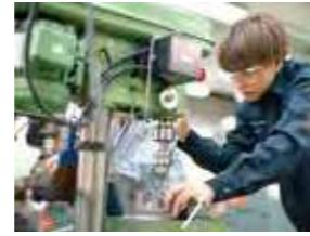
旋盤やフライス盤、ボール盤など様々な工作機械を駆使し、自分で書いた図面を見ながら部品の加工を進めます。ここでの加工精度がエンジン性能を左右します。加工した部品を組み立て、細かな調節をしながら、スターリングエンジンを完成させていきます。
