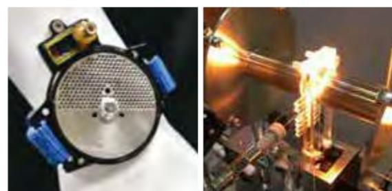
▲静電気を用いて発電する回転型エレクトレット振動発電器
