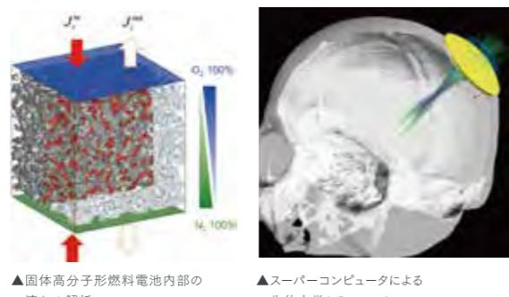
▲固体高分子形燃料電池内部の流れの解析
