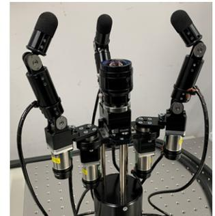
図1 高速ロボットハンド
