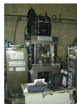
高温高速圧縮試験機
