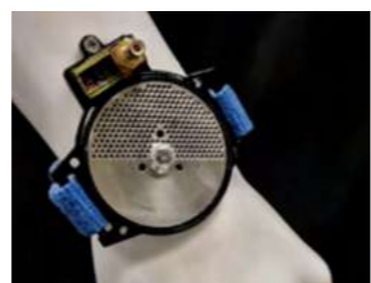
静電気をを用いて発電する回転型エレクトレット振動発電器
